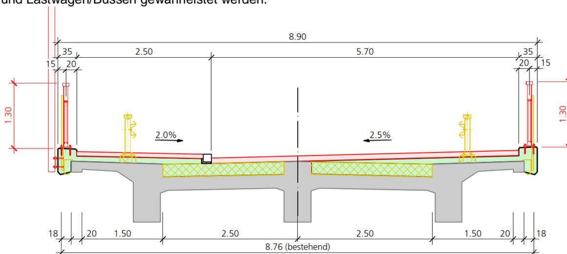
Abb. 4: Brückenquerschnitt
