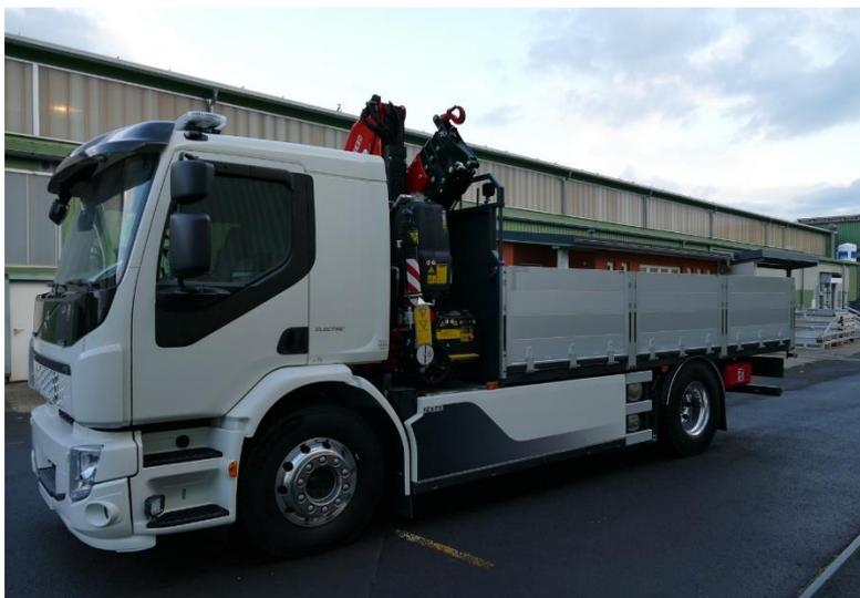
Abbildung 2: Vollelektrolastwagen mit Kran. Quelle: Volvo Group (Schweiz) AG
