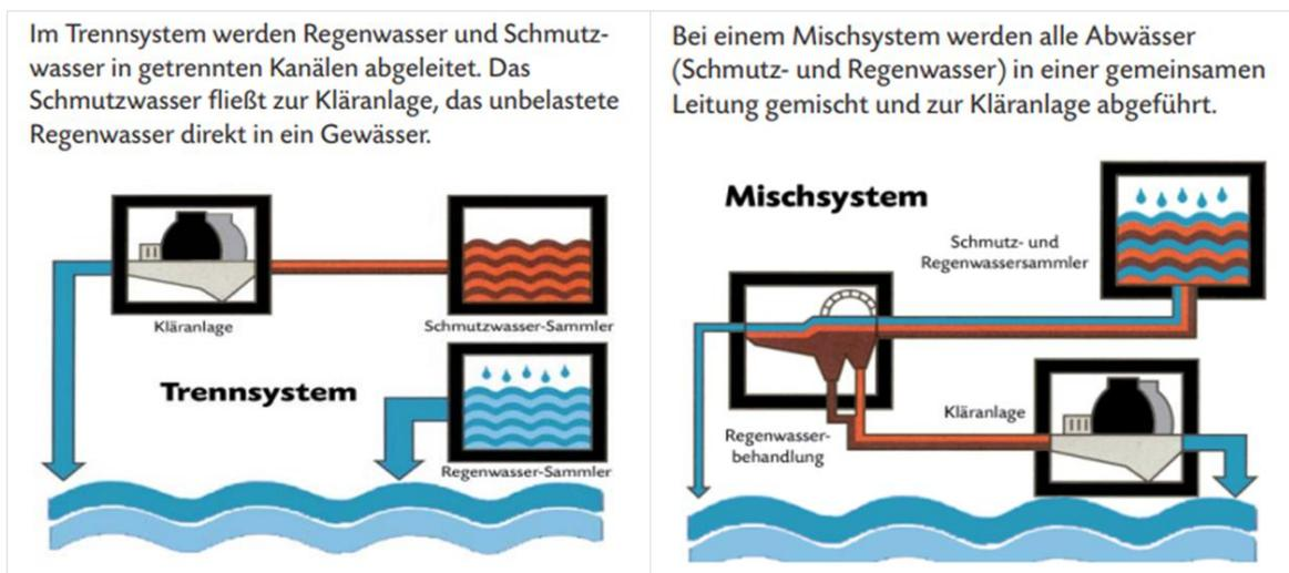
*Abbildung 1: Darstellung Entwässerungssysteme*
