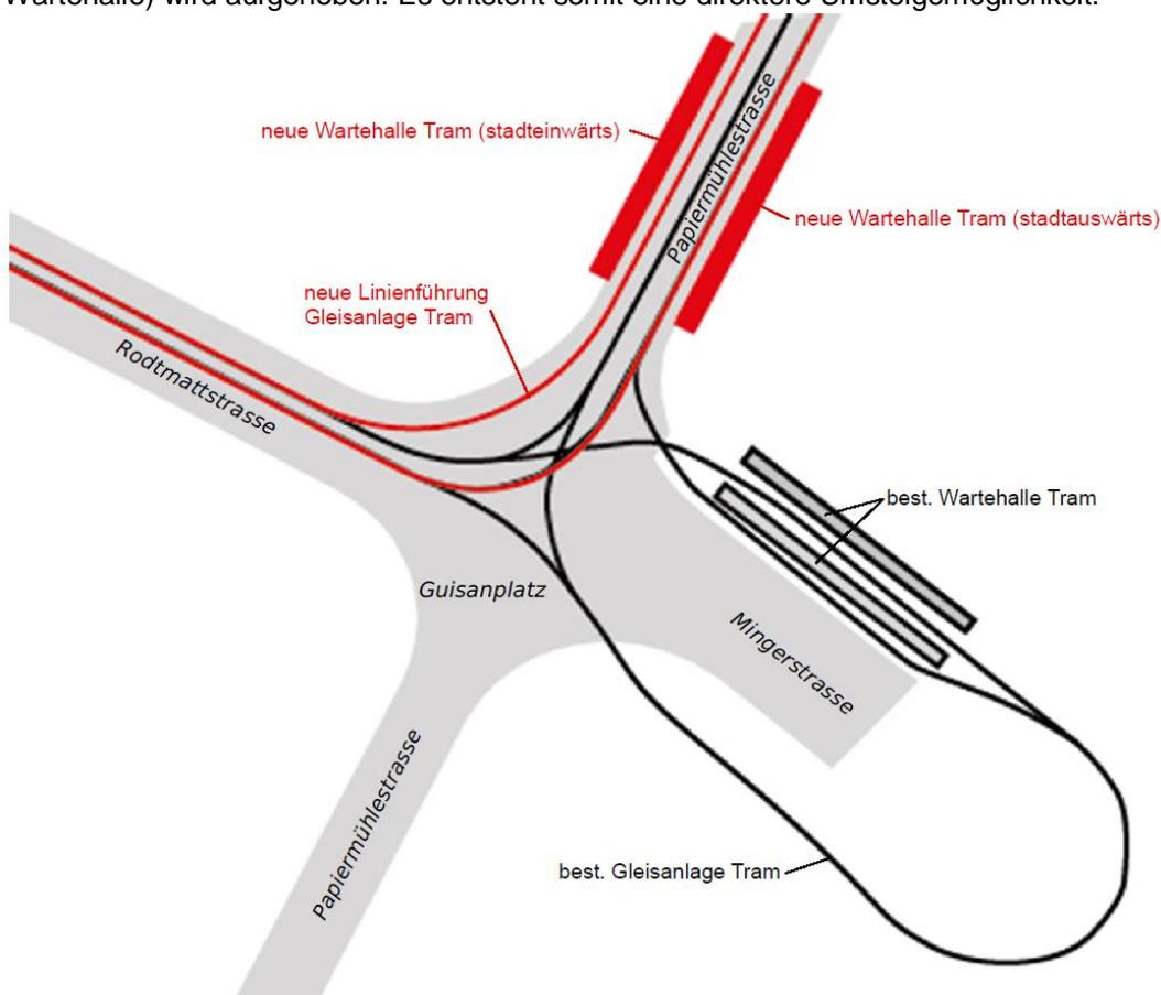
Abbildung 1: Systemskizze neue Tramführung Guisanplatz mit neuen Haltestellen
