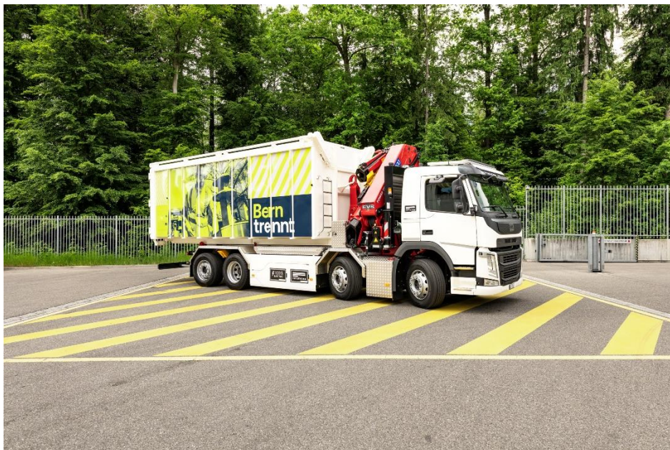
Abbildung 1: Vollelektro-Hakenfahrzeug mit Kran und 36 m 3 Mulde. Quelle: ERB.
