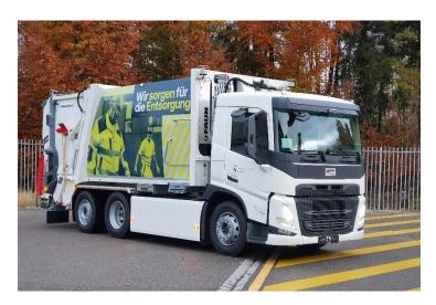
Abbildung 1: Vollelektro-Kehrichtwagen mit konventionellem Aufbau. Quelle: ERB.
