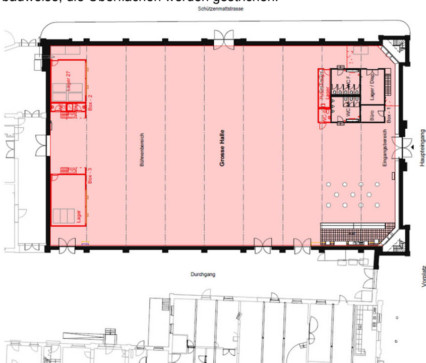
Grundriss Grosse Halle, bauliche Massnahmen in rot
