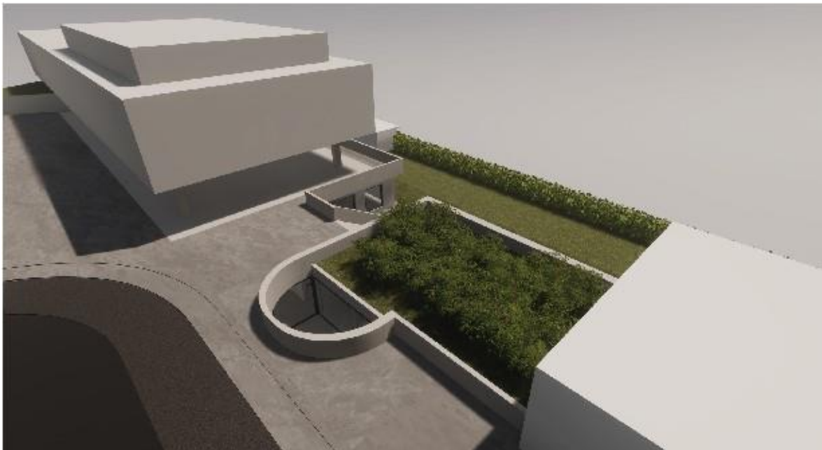
Schematische Darstellung der Baukörper. Oben: Kirchgemeindehaus, mittig der (bepflanzte) Zwischenbau mit Treppe zum UG und Lichthof, unten das bestehende Pfarrhaus.
