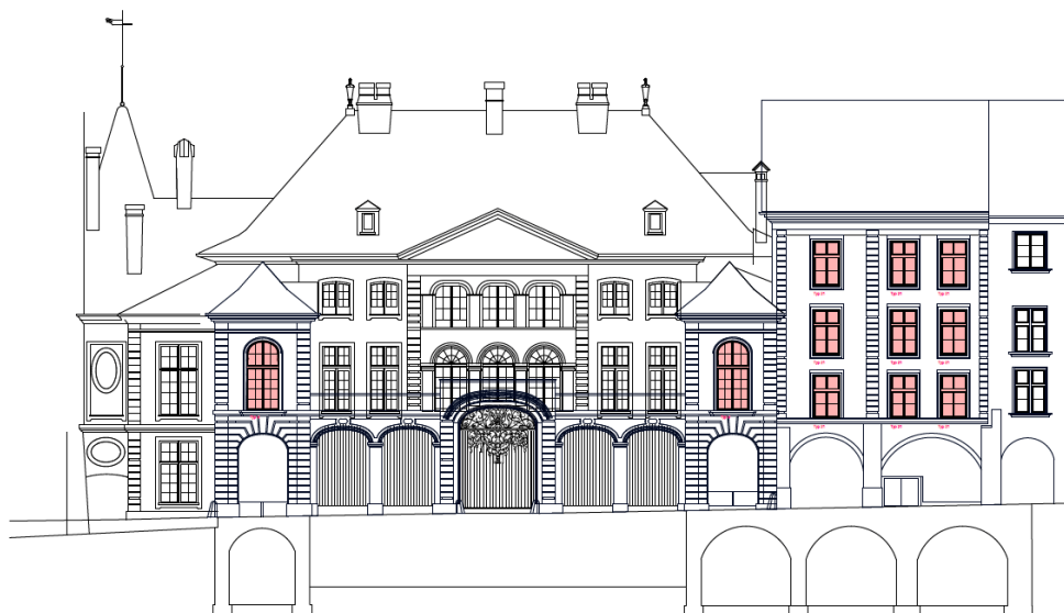
Nordfassade mit den zu ersetzenden Fenstern (rot)
