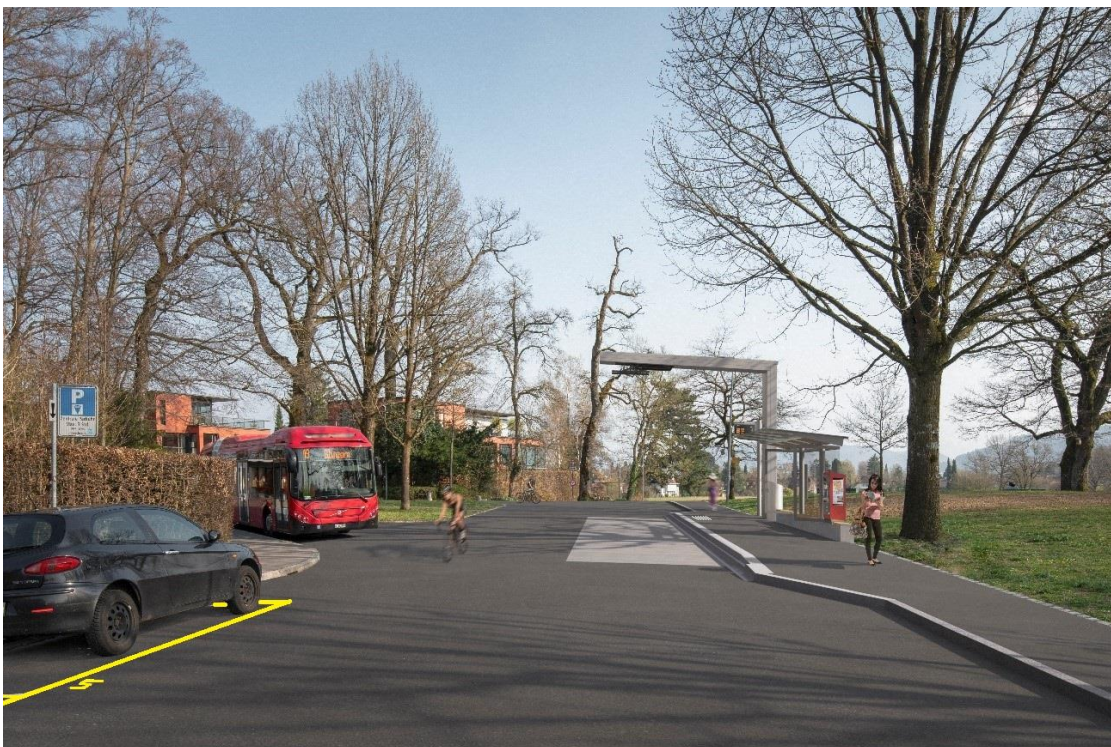
Abbildung 1: Visualisierung der Haltekante (inkl. Ladearm) der neuen Haltestelle Elfenau. Sie liegt auf Seite Elfenaupark und ist mit einer Wartehalle ausgerüstet. Die dargestellte Szene zeigt den abfahrenden Bus, nachdem er an der Haltestelle gewartet und die Batterie aufgeladen hat
